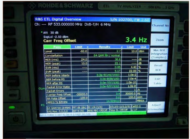
圖3 射頻頻率量測-頻率容許差度
