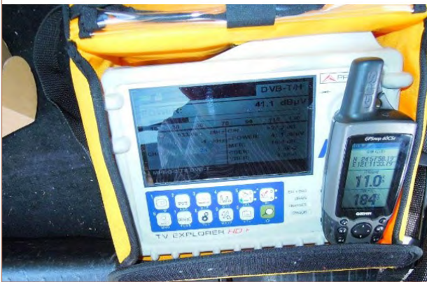
圖10 主要服務區電場強度量測
